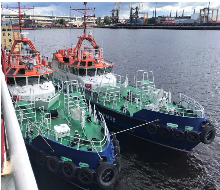
Проект ST23WIM. Первые в России катера с гибридной установкой построены по проекту, разработанному Конструкторским бюро "Морская Техника". Фото: «МТ-Групп»
